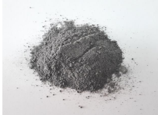
Şekil 1. Genleştirme öncesi ham perlitin genel görünümü.
