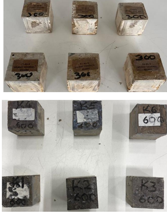
Şekil 6. Yüksek sıcaklıktan sonra numunelerin görünümü
